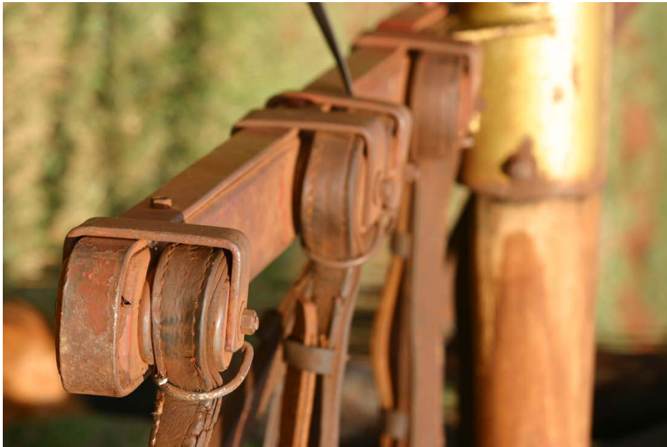
Figura 4: Sostenido por esa diagonal, una barra horizontal en la medida del cuerpo de los cuatro caballos recibe la fijación del sistema de roldanas que mantiene las riendas interconectadas. El conductor mueve los cuatro caballos por medio de las dos riendas que sostiene en cada una de las manos.
