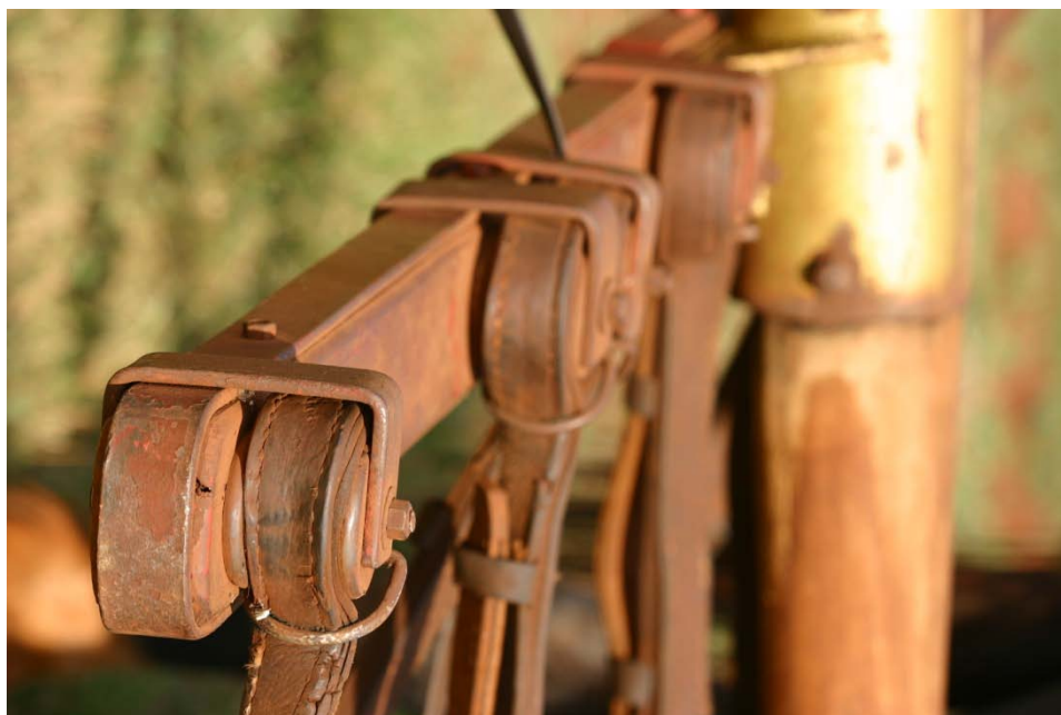
Figura 4: Sustentado por essa diagonal, uma barra horizontal na mensuração do corpo dos quatro cavalos recebe a fixação do sistema de roldanas que mantém as rédeas interligadas. O condutor move os quatro cavalos pelas duas rédeas que ele sustenta uma em cada mão.
