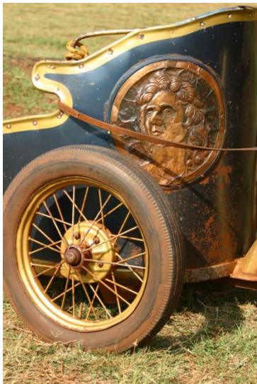
Figura 2: Lateral do carro de alumínio com busto grego esculpido em bronze e pneu fino para suavizar o impacto no terreno irregular.
